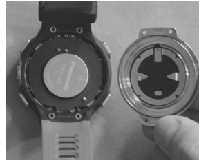
СНЯТИЕ КРЫШКИ БАТАРЕЙНОГО ОТСЕКА
