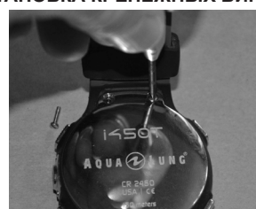
УСТАНОВКА КРЕПЕЖНЫХ ВИНТОВ
