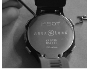
ОСВОБОЖДЕНИЕ КРЫШКИ БАТАРЕЙНОГО ОТСЕКА
