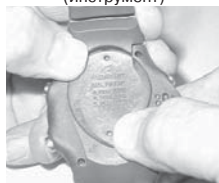
Рис. 112В - АЛЬТЕРНАТИВНОЕ СНЯТИЕ КРЫШКИ
